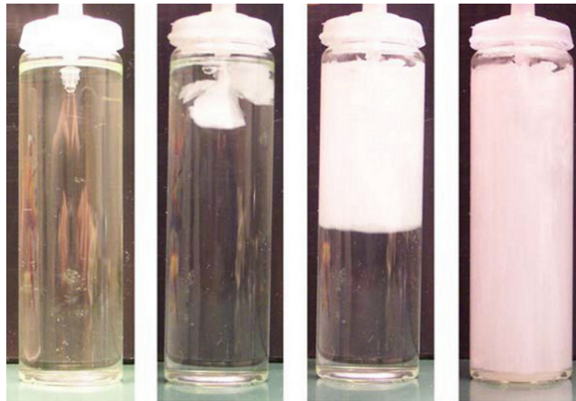
Figure 2.13 – Déclenchement de la solidification par ensemencement [64]
