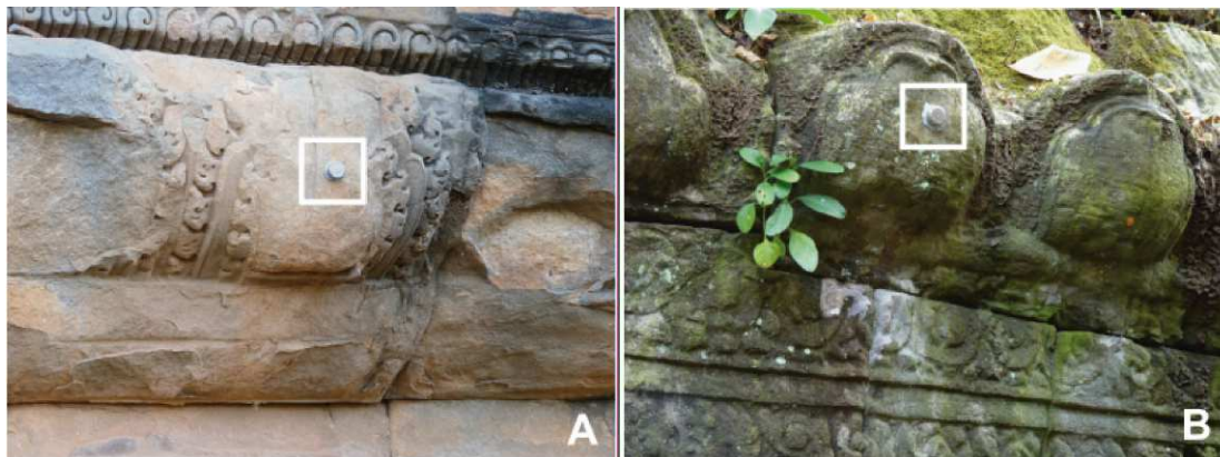
Figura 8: Sensores de monitoring climático utilizados en Angkor (André et al. 2012b).
