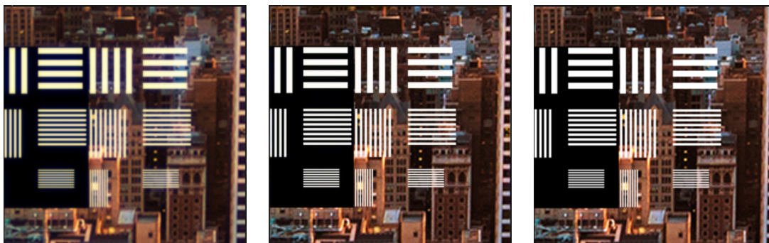
FIGURE 4.24 – Imagerie d'une taille de 200 \times 200 pixels extraite au centre de l'image. De gauche à droite : Image dégradée, image corrigée, et image de référence.
