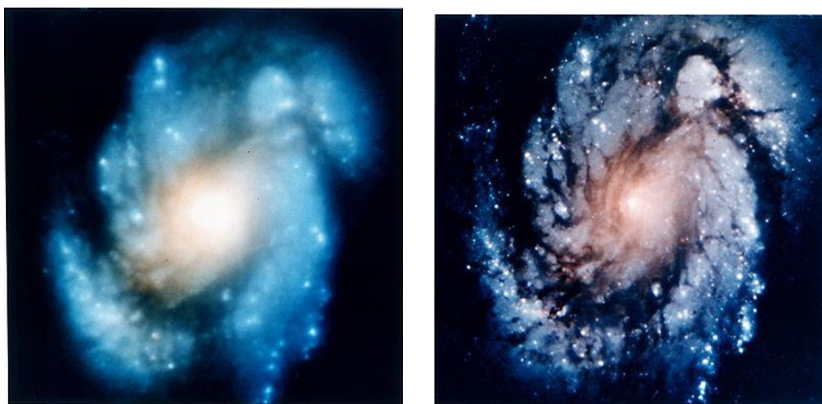
FIGURE 2.21 – Exemple d'une image floue prise par Hubble après son lancement ( gauche ), et une image prise après la mission de réparation de son miroir STS-61 ( droite )
