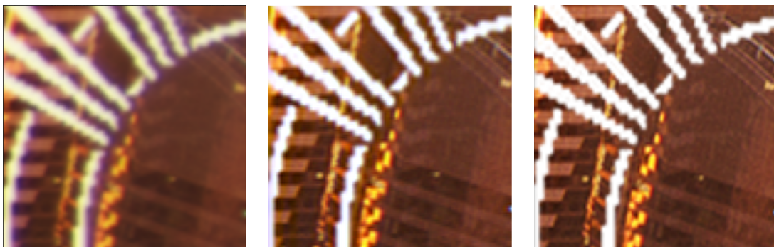
FIGURE 4.26 – Imagerie d'une taille de 100 \times 100 pixels extraite sur un bord de l'image. De gauche à droite : Image dégradée, image corrigée, et image de référence.
