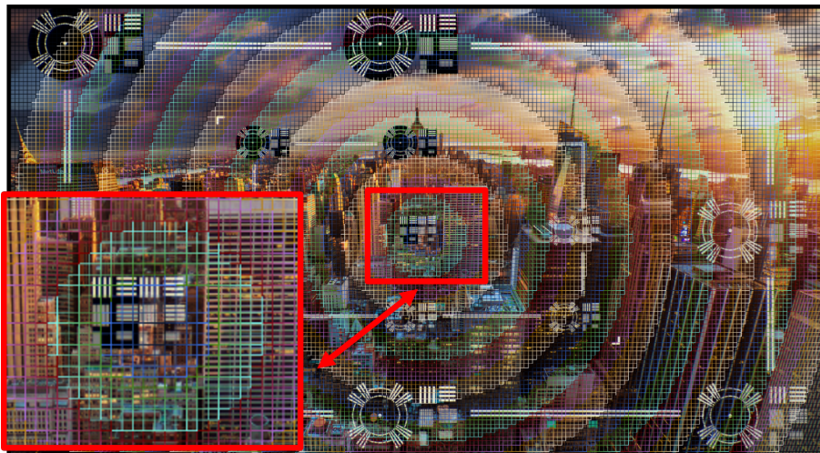
FIGURE 4.20 – Image source divisée en blocs, chaque bloc utilise une PSF différente.
