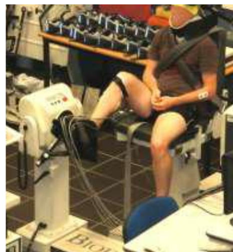
Figure 19 : Biodex System 4 et installation du sujet pour tous nos protocoles expérimentaux
