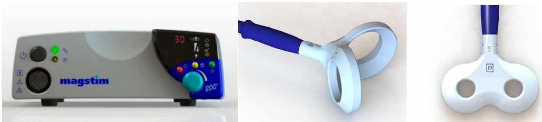
Figure 15 : stimulateur magnétique transcrânien Magstim, bobine double cône et bobine « figure en huit ».
