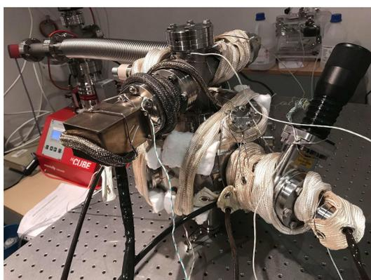
*Mise en place de cordons chauffants et de thermocouples pour le suivi de la température*
