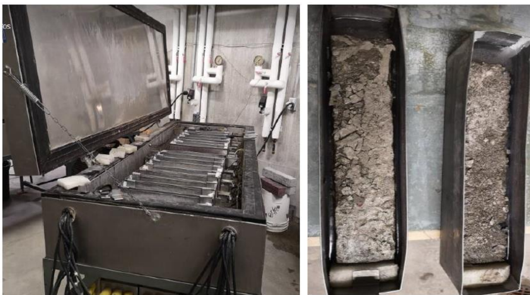
Figure 7-19 : Les poutres d'essais placés dans les bacs de gel-dégel après 60 cycles
