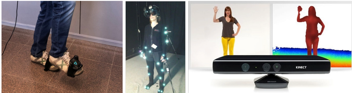
FIGURE 2.22: Exemple d'interfaces de localisation corporelle : capteur Vive Tracker (gauche, utilisé par Salvetti et al. [26]), combinaison de suivi de mouvements (centre, Hamilton-Giachristis et al. [27]), système Microsoft Kinect (droite)
