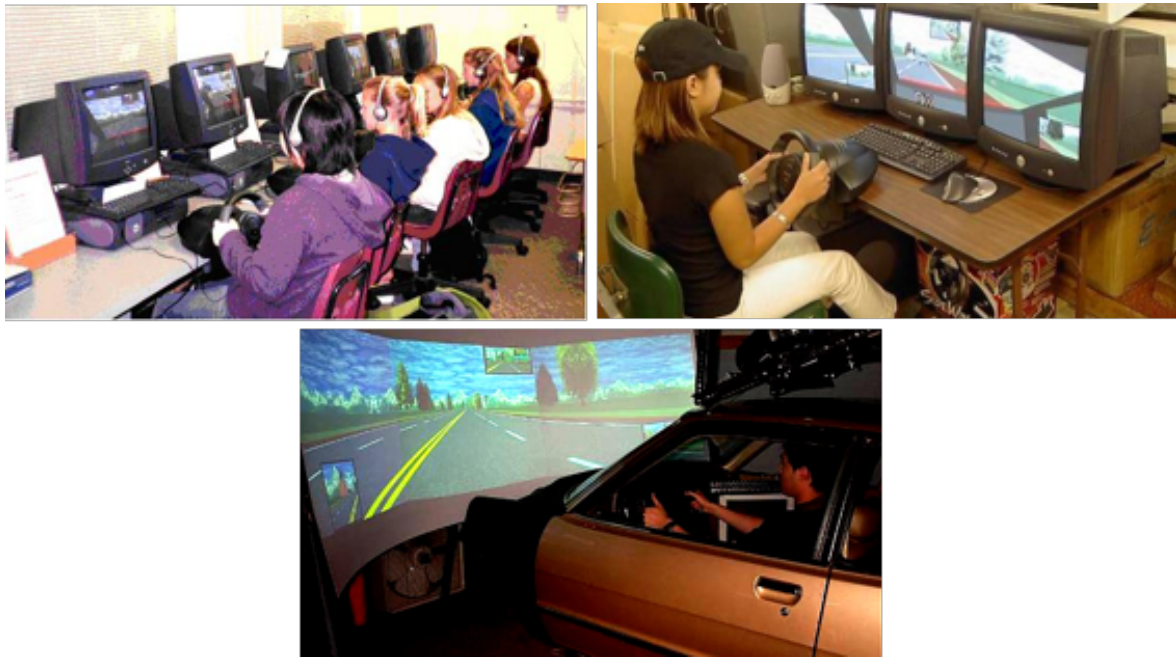
FIGURE 3.7: Allen et al. [33], simulateurs d'apprentissage à la conduite selon différents niveaux de fidélité
