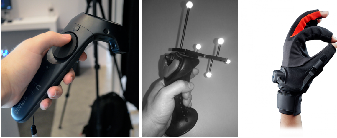
FIGURE 2.20: Exemple d'interfaces de commande et d'interaction : contrôleur Vive Controller du visiocasque HTC Vive (gauche), pointeur spatialisé utilisé dans une salle immersive (centre, Winkes et Aurich [23]), gants connectés Manus VR Prime One (droite)
