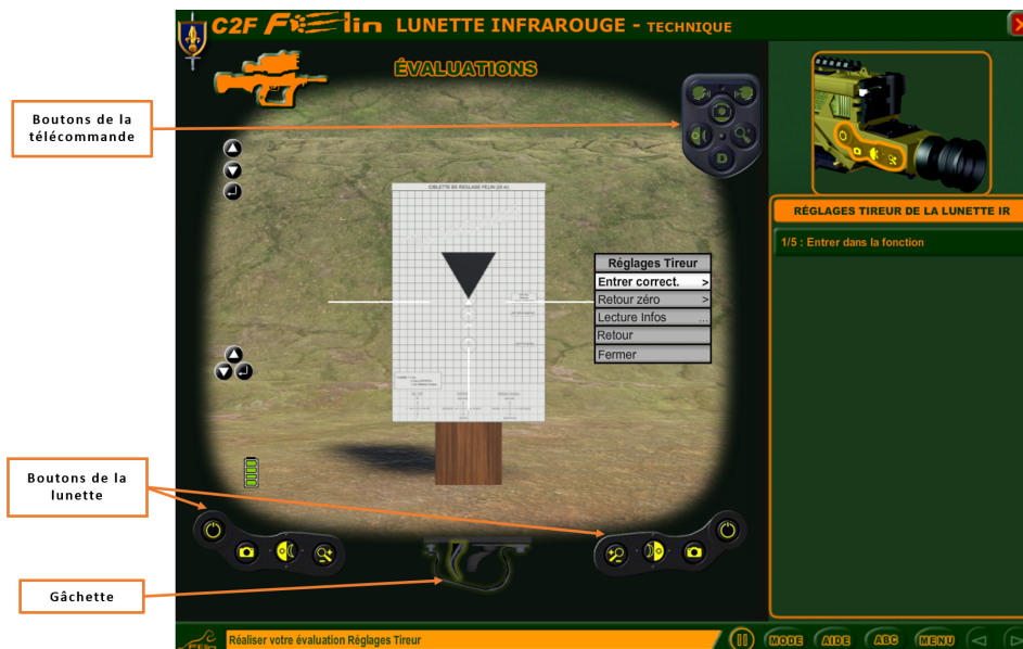
FIGURE 3.3: EAO FÉLIN, module d'entraînement aux réglages tireurs de la lunette infrarouge
