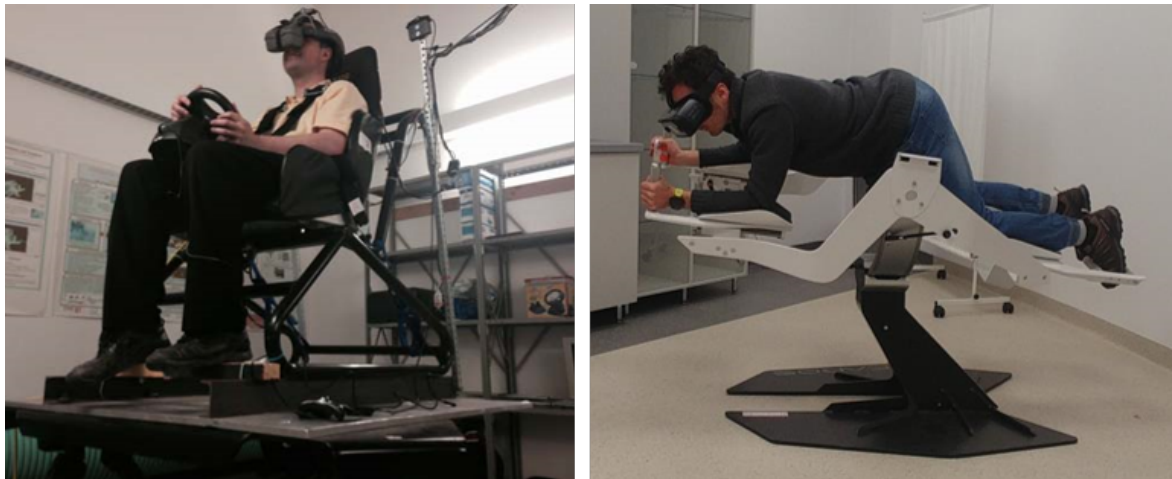
FIGURE 2.19: Exemple d'interfaces à simulation de mouvement : travaux de Codd et al. [21] sur un siège à stimulation de mouvements (gauche), dispositif commercial Icaros pro (droite, utilisé par Dkebska et al. [22])
