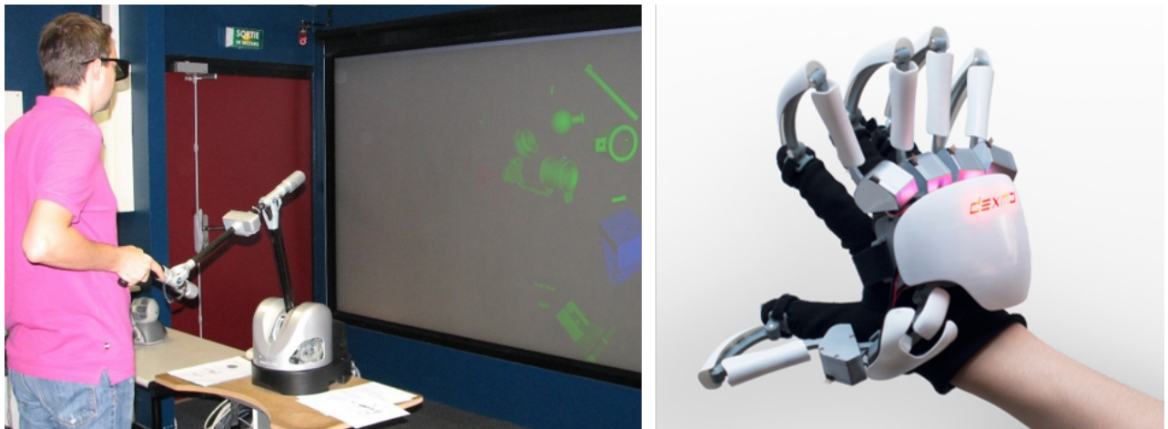
FIGURE 2.23: Exemple d'interfaces sensorimotrices : Haption Virtuose 6D (gauche, Iacob et Popescu [28]) et gant à retour d'efforts Dexmo (droite)
