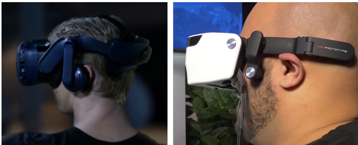
FIGURE 2.16: Exemple d’interfaces acoustiques intégrées aux visiocasques : casque stéréophonique du HTC Vive Pro (gauche) et dispositif sonore par conductance osseuse intégré au prototype VR Headset de Panasonic (droite), présenté lors du CES 2017
