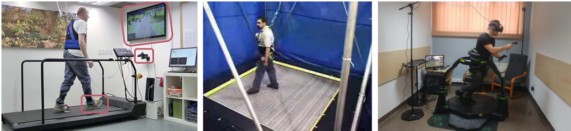
FIGURE 2.21: Exemple de plateformes directionnelles : tapis monodirectionnel (gauche, Dockx et al. [24]), tapis omnidirectionnel (centre, Robuffo et al. [25]), dispositif commercial de plateforme omnidirectionnelle Virtuix Omni (droite, utilisé par Dkebska et al. [22])
