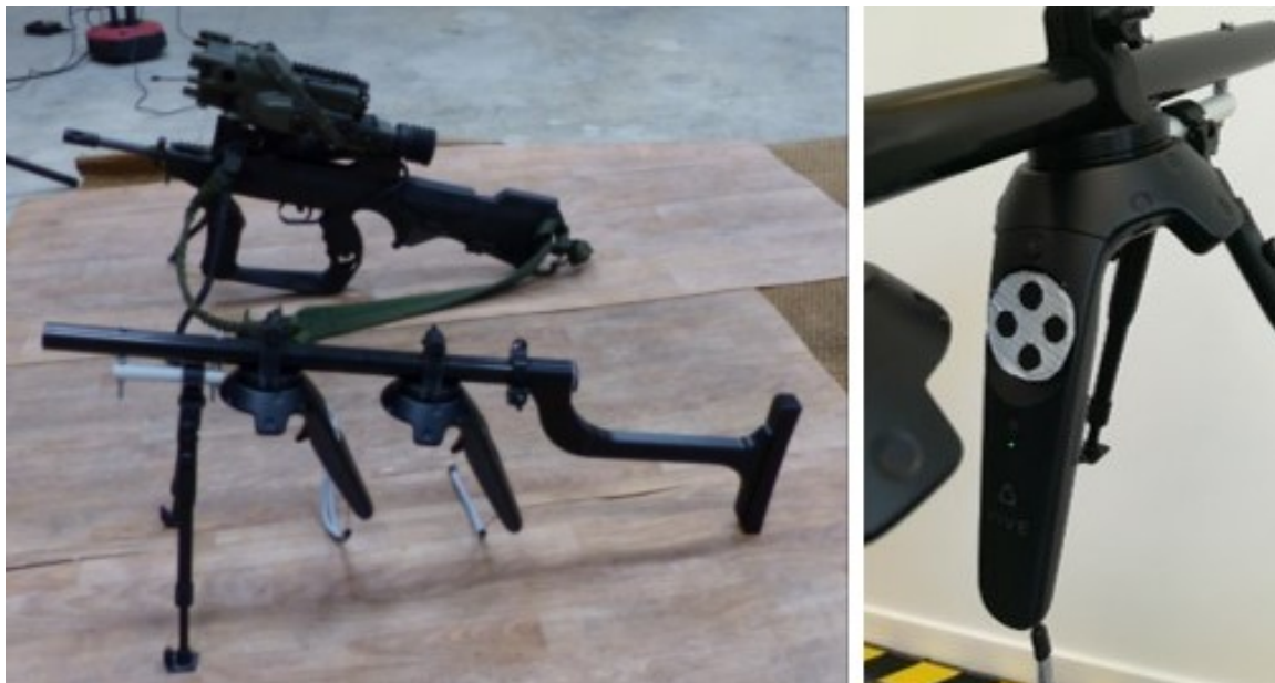
FIGURE 3.13: Support des contrôleurs et fusil FAMAS (gauche), masque adhésif ajouté au Vive Controller avant (droite)
