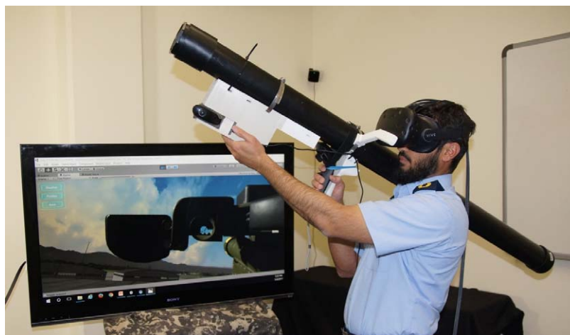
FIGURE 3.9: Rashid [35], étude de faisabilité de l'utilisation d'éléments sur étagère comme interfaces haptiques passives, pour la formation au maniement d'armes anti-aériennes
