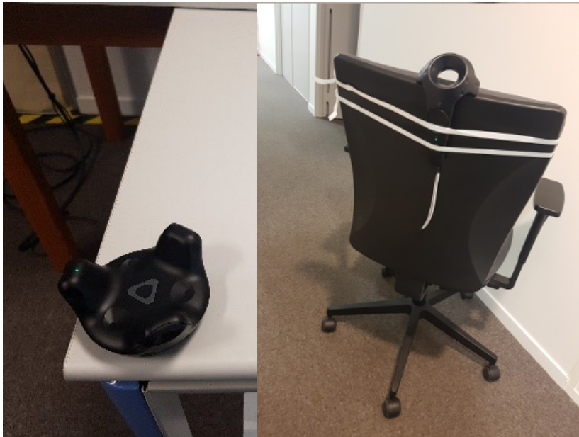
FIGURE 4.27: VIVE Tracker fixé à la table (à gauche) et VIVE Controller fixé à la chaise (à droite)
