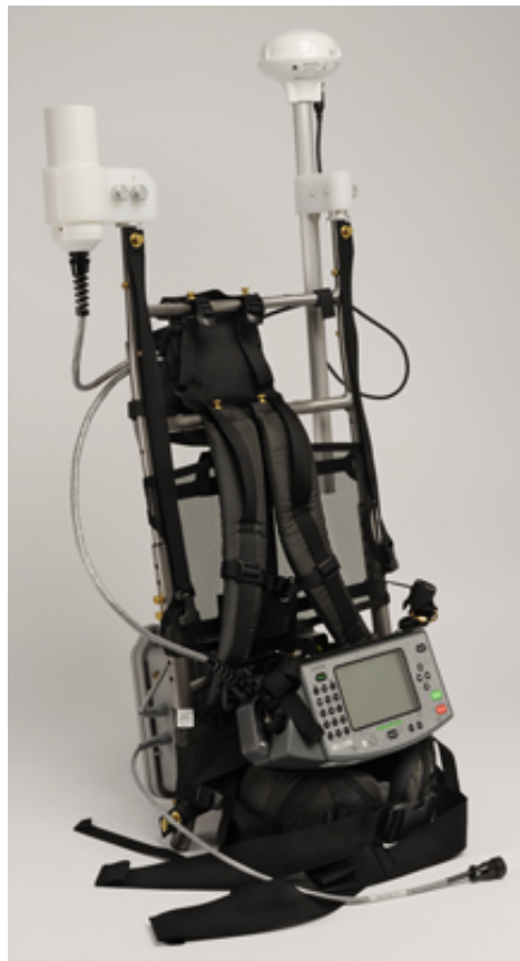
FIGURE I.4 – Magnétomètre à pompage optique césium, le G859 produit par Geometrics. Il est ici équipé sur sac à dos avec à droite le GNSS et l'électronique de contrôle en bas. Source : site Geometrics, http://www.geometrics.com/geometrics-products/geometrics-magnetometers/g-859-magnetometer/
