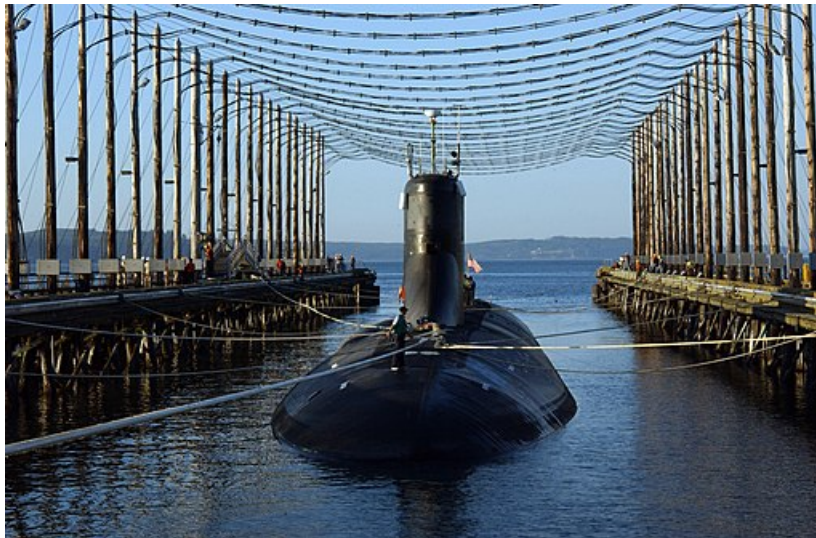
FIGURE I.17 – Sous-marin Américain à l’intérieur d’une station de deperming type drive-in. Photographie par US Navy, domaine public.
