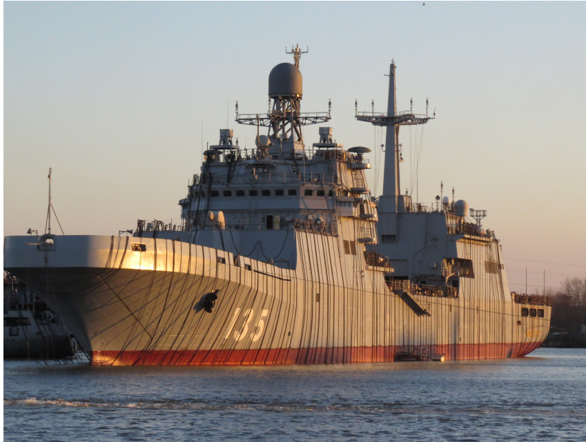
FIGURE I.16 – Un navire russe durant un deperming sur station de type wrapping. Photo par Mikhiylov - Wikimedia
