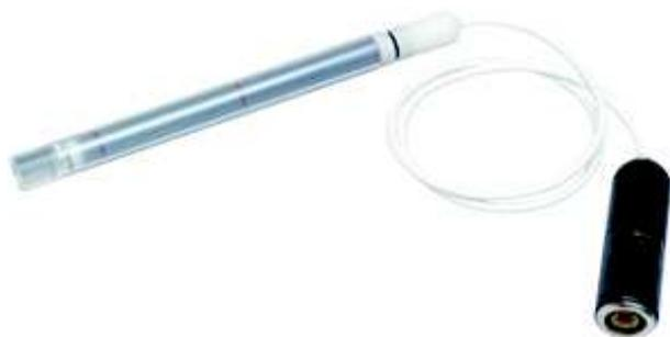
*Figure 2.9: Chambre d'ionisation 10X5-3 CT<sup>1</sup>.*
