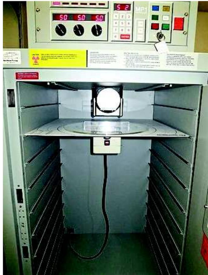
Figure 2.6: Générateur de rayons X Faxitron CP-160.
