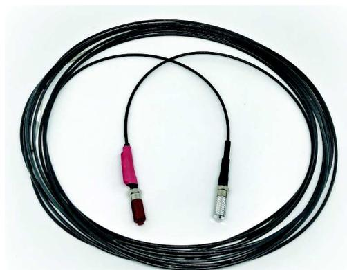
Figure 1.18: Fibre optique scintillante et fibre de transport.
