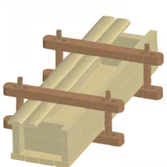
Figure II.46 : Schéma simplifié du système de fermeture « en étau » (S. Duchesne).
