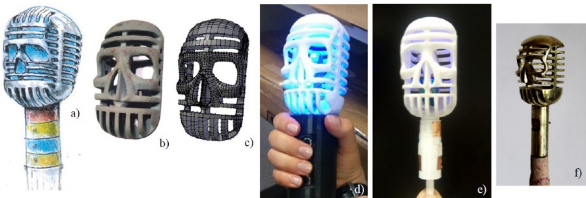
Figure 129 : Évolution de la sculpture connectée a) ébauche b) maquette en polypropylène c) modèle 3D d) premier prototype e) second prototype f) objet final
