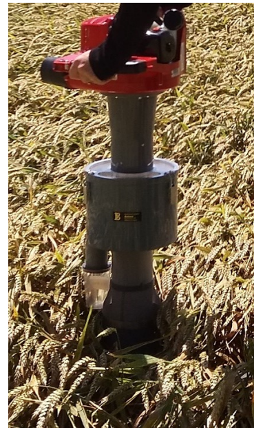
Figure II.5: Utilisation du « vortis » pour capturer les proies animales et les graines. Photographie : B. Carbonne.
