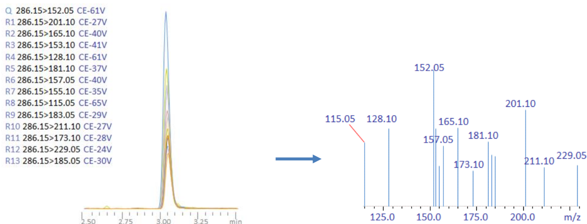
Figure 21 : construction d'un spectre de masse à partir des intensités d'un pic chromatographique
