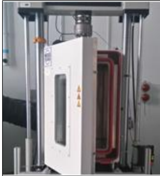
Fig. II.14 : Enceinte climatique permettant de contrôler la température et l'hygrométrie lors des essais de traction et de fatigue sur composites.
