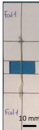
Fig. II.16 : Exemple d'éprouvette de fil de chanvre seul, sur son support en papier.
