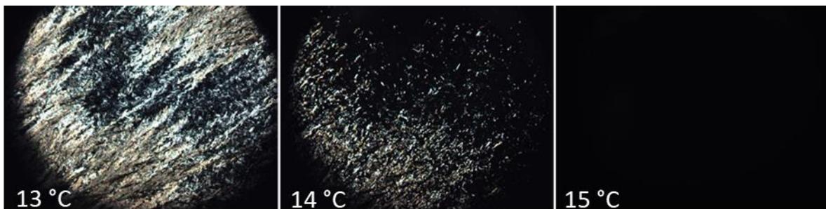
Figure 3-5 : Images de la fusion de l'acide oléique pur (de gauche à droite) obtenue par microscopie sous lumière polarisée. La taille des images correspond à 5 mm<sup>2</sup> de l'échantillon.
