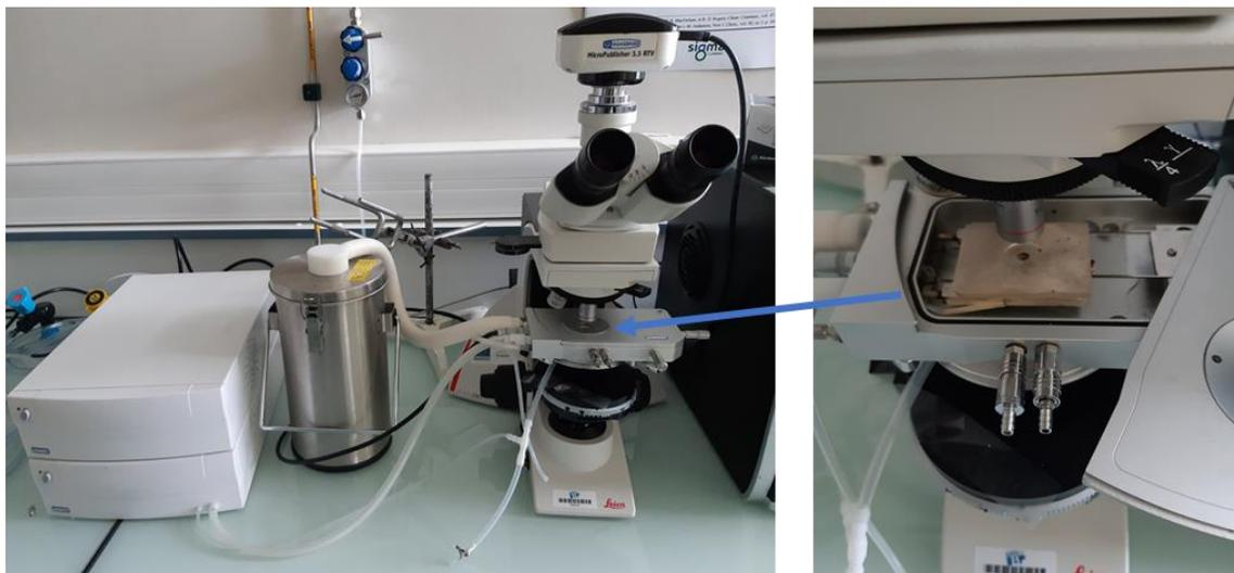
Figure 2-10 : Photographies du microscope optique, avec un zoom de la platine chauffante à droite. Sur la photographie de gauche, on peut observer (de gauche à droite) les contrôleurs de la platine Linkam (en blanc), le Dewar pouvant contenir de l'azote liquide qui permet de refroidir la platine thermo-régulée et le microscope équipé de platine thermo-régulée et de la caméra (en haut).
