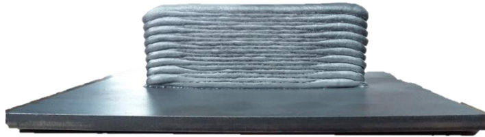
Figure 6-14 : mur monocordon WAAM considéré pour l'application de la simulation numérique à la prédiction des temporisations.
