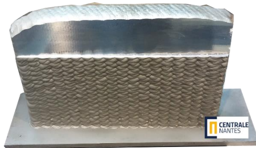
Figure 5-11 : mur multicordon en alliage d'aluminium WAAM sélectionné pour la qualification de la méthode CND.
