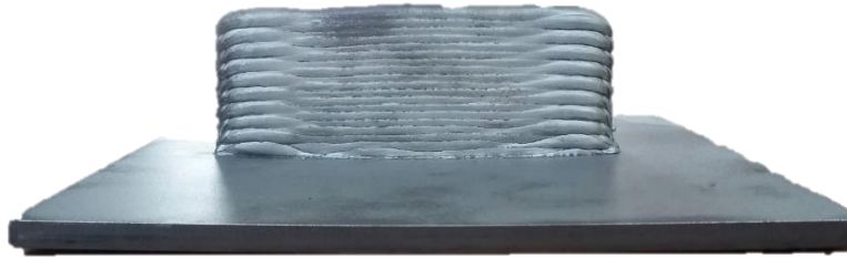
Figure 3-10 : spécimen sélectionné pour l'étude de justesse de la mesure géométrique.
