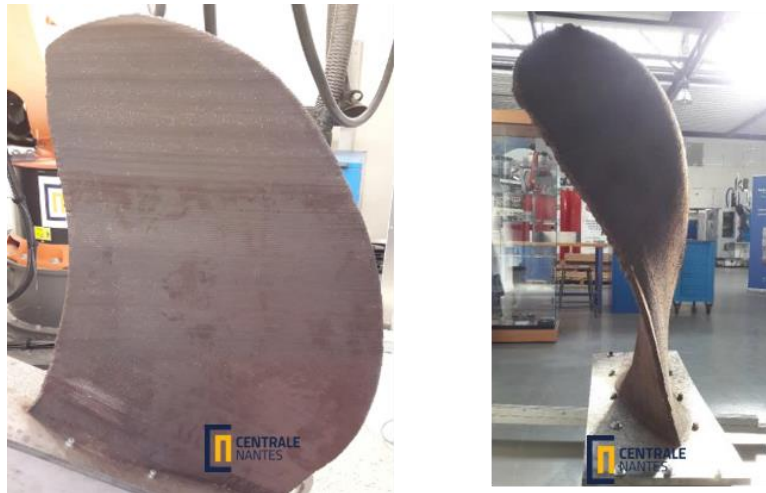
Figure 6-17 : vues de face et de côté d'une pale d'hélice navale fabriquée à Centrale Nantes.
