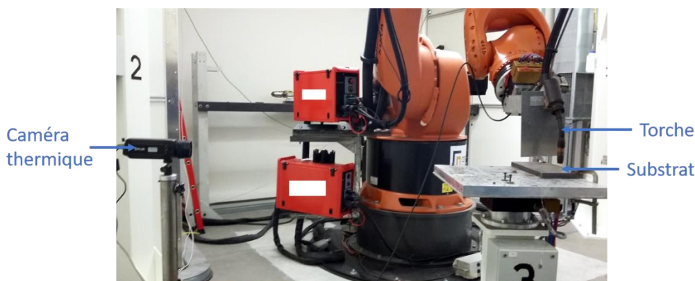
Figure 2-20 : montage expérimental pour le monitoring thermique appliqué au procédé WAAM.
