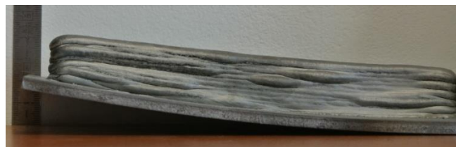
Figure 6-8 : mur multi-cordons fabriqué en WAAM pour la comparaison des logiciels.
