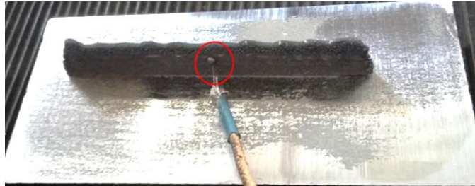
Figure 2-9 : illustration du thermocouple inséré dans le mur lors de la calibration de l'émissivité pour le procédé LMD.
