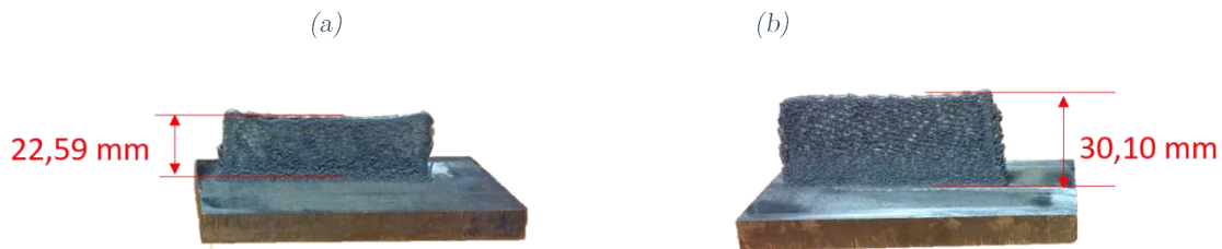
Figure 2-15 : murs fabriqués dans le cadre de l'étude de la grandeur physique ZHT_{1000^{\circ}C} . (a) mur A (b) mur B.
