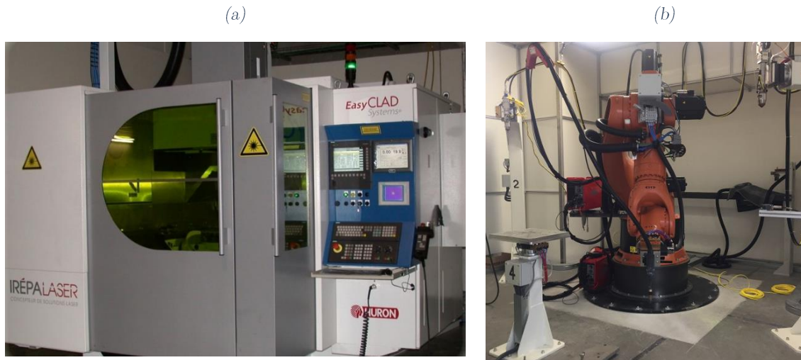
Figure 1-12 : (a) machine CLAD ® mise en œuvre pour le procédé LMD, (b) cellule robotisée multiprocédé mise en œuvre pour le procédé WAAM.
