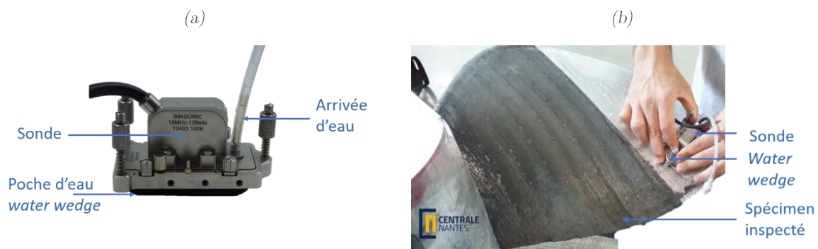
Figure 5-2 : (a) montage de la sonde sur un water wedge et (b) montage expérimental dans le cadre de l'application au procédé WAAM.
