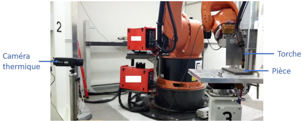
Figure 2-3 : montage expérimental pour le monitoring thermique appliqué au procédé WAAM.
