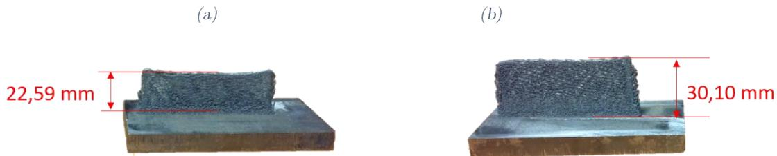
Figure 2-15 : murs fabriqués dans le cadre de l'étude de la grandeur physique  $ZHT_{1000^{\circ}\text{C}}$ . (a) mur A (b) mur B.
