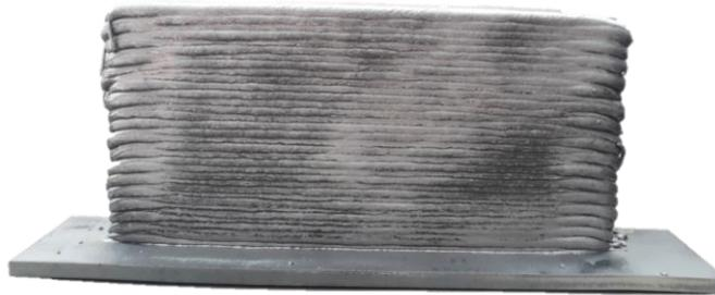
Figure 4-19 : mur monocordon fabriqué pour valider le modèle de contrôle sonore.
