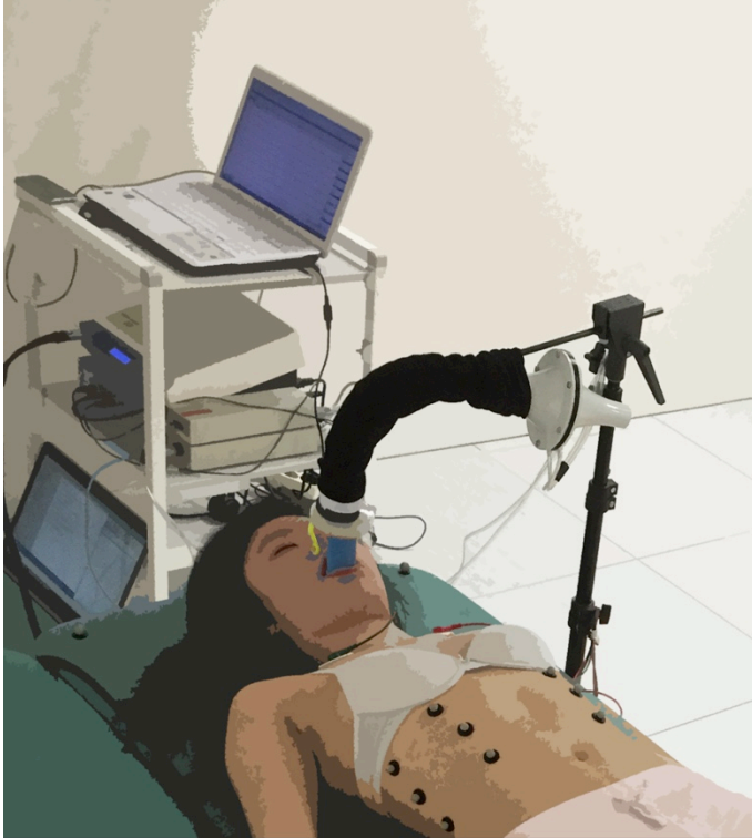
Figure – 1.1 : Sujet positionné en décubitus dorsal équipé du spiromètre suspendu à une potence afin de maintenir confortablement la tête dans l’axe.
