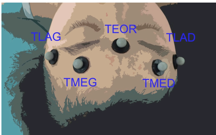
Figure – 3.1 : disposition des marqueurs rétro-réfléchissants du crâne : 5 marqueurs sont positionnés en projection de l'os frontal du sujet.
