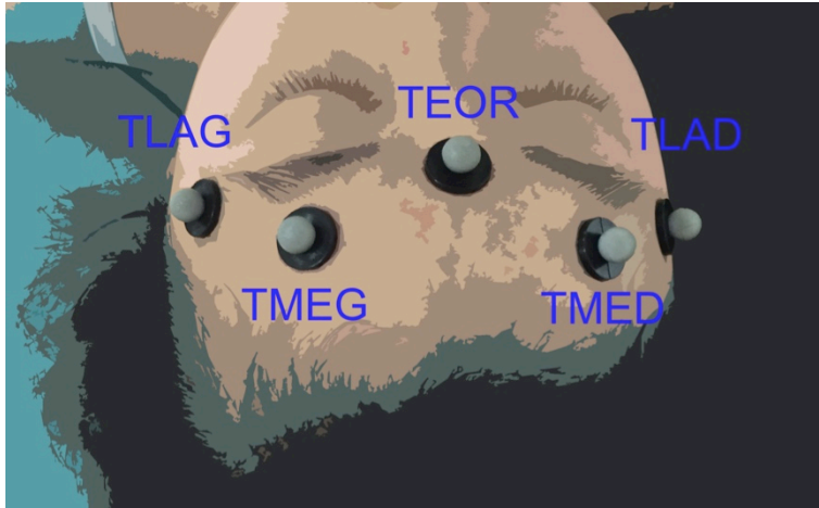
Figure – 2.1 : disposition des marqueurs rétro-réfléchissants du crâne : 5 marqueurs sont positionnés en projection de l'os frontal du sujet.
