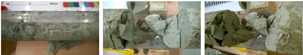
Figure 2.33 : Carotte_25,6-27,1 dans les marnes infragypseuses
