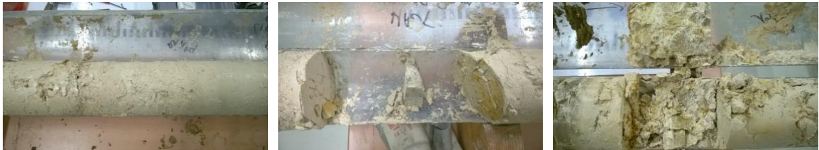
Figure 2.32 : Carotte_18,2-19,7 dans les masses/marnes/gypse
