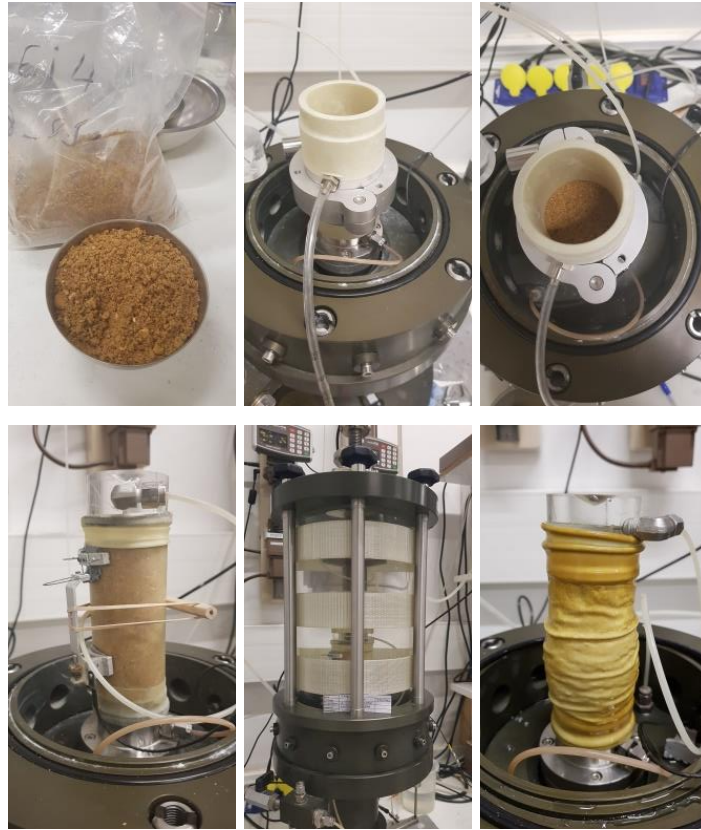
Figure 2.36 : Essai triaxial drainé sur des alluvions
