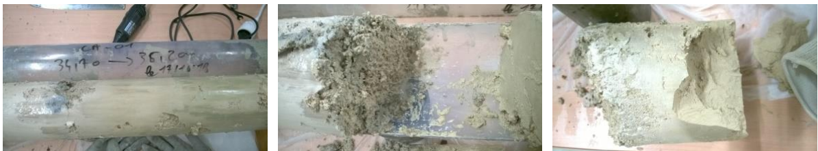
Figure 2.34 : Carotte_34,7-36,2 dans le calcaire de St Ouen
