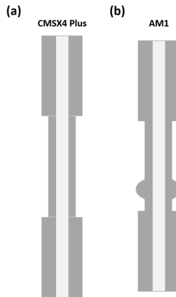
figure 124 - Déformées macroscopiques typiques des éprouvettes en fonction des superalliages considérés : (a) CMSX4 Plus, (b) AM1
