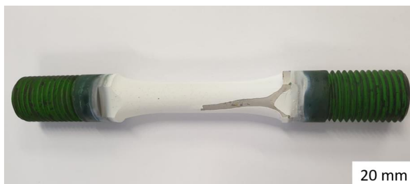
figure 173 - Ecaillage de l'éprouvette fluée
