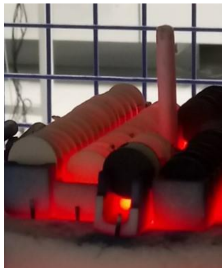
figure 12 - Pions testés lors du refroidissement à l'air
