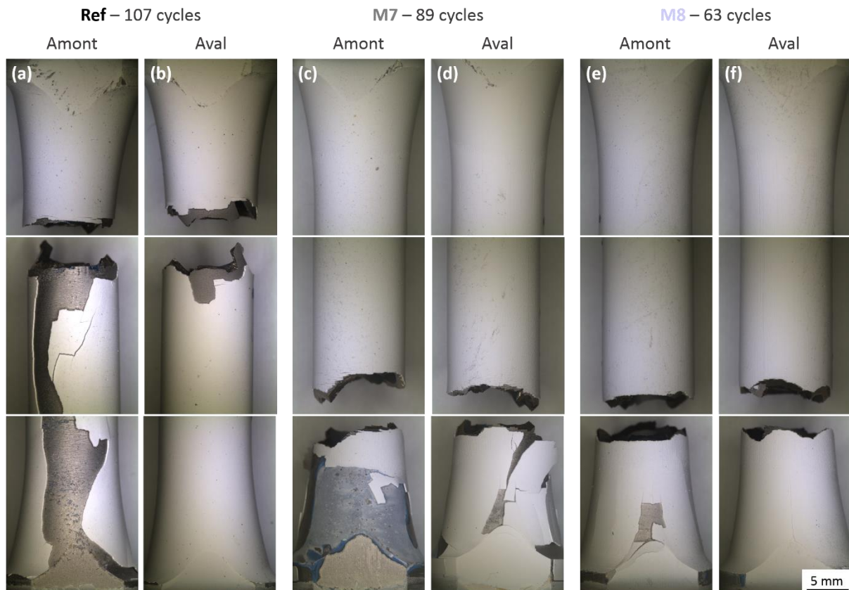
figure 146 - Zones d'écaillage des éprouvettes revêtues non vieilles : (a) référence, face amont ; (b) référence, face aval ; (c) éprouvette M7, face amont ; (d) éprouvette M7, face aval ; (e) éprouvette M8, face amont ; (f) éprouvette M8, face aval
