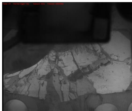
Figure VI-39. Dernière image d'acquisition à 2 Mfps d'un essai EOI sur MAINa-90° impacté dans son sarcophage (vitesse d'impact supposée : 178 m/s).
