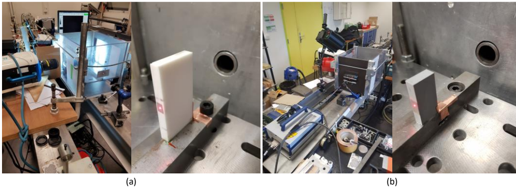
Figure VI-8. Montage EOI ouvert avec un échantillon (a) 60 \times 30 \times 7 \text{ mm}^3 d' \text{Al}_2\text{O}_3 et (b) 36 \times 18 \times 7 \text{ mm}^3 de MAINa.
