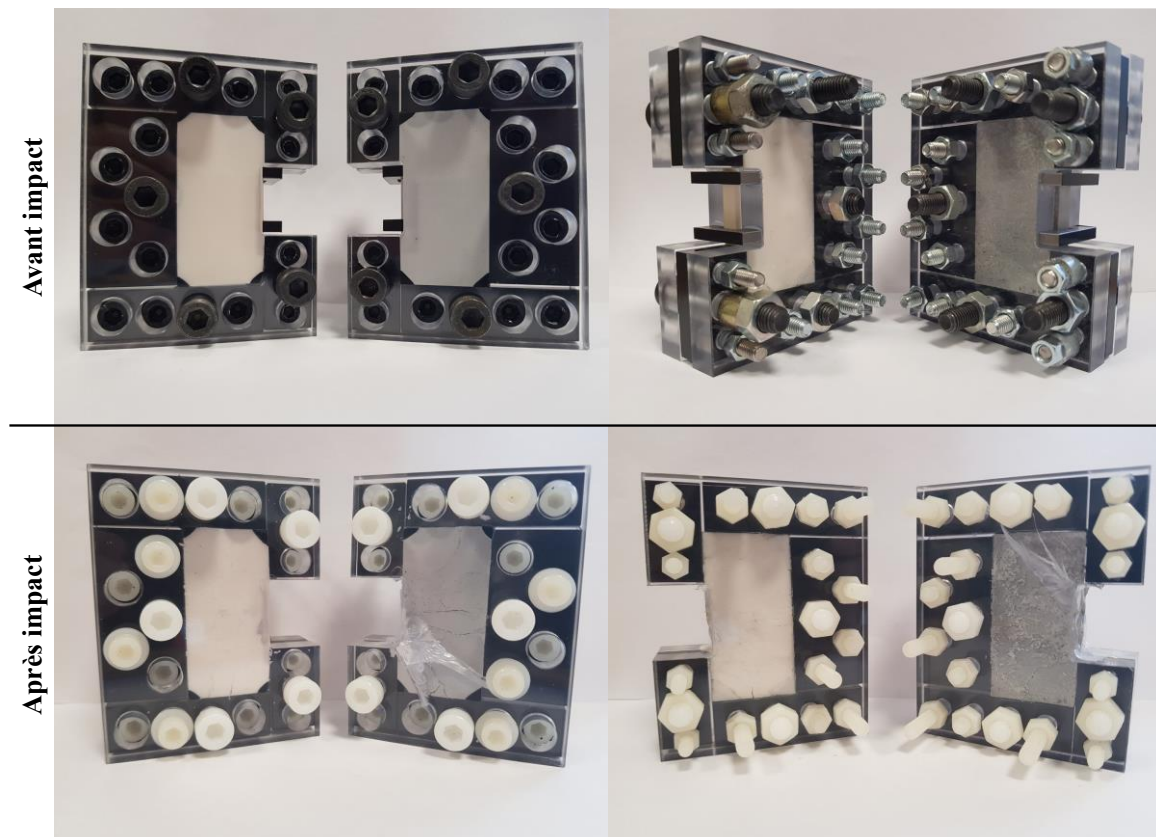
Figure VI-21. Carreaux de céramiques (Al 2 O 3 et MAINa-90°) placés dans le sarcophage, avant et après impact.
