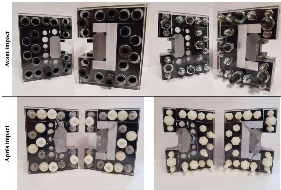
Figure VI-38. Carreaux de céramiques (MAINa-90° et MAINa-0°) placés dans le sarcophage, avant et après impact.
