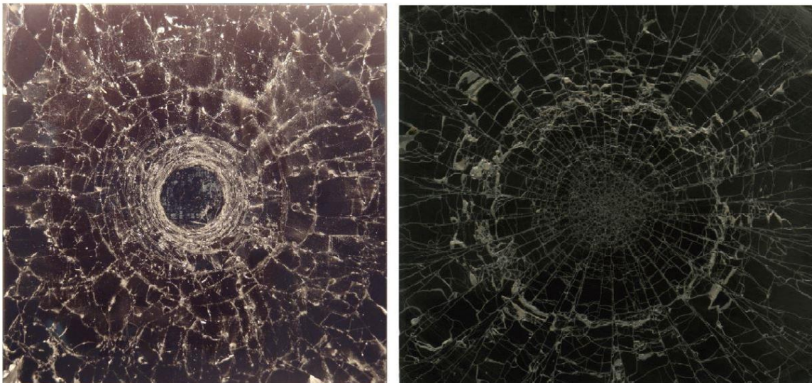
Figure I.6. Vues post-mortem des faces avant (à gauche) et arrière (à droite) d'un SiC (Hexoloy SA®) illustrant la propriété des céramiques à fissurer et à fragmenter [23].
