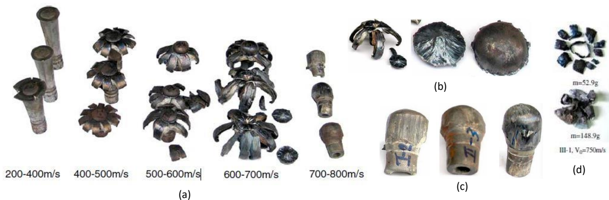
Figure I.21. (a) Variations des modes de déformation et de rupture de projectiles cylindriques à différentes vitesses d'impact. (b) Rupture de projectiles en mode II (600 m/s) avec chapeau séparé. (c) Rupture de projectiles en mode III (750 m/s). (d) Fragments de pétales et de morceaux récupérés après un impact en mode III. (Adaptée de : [52]).
