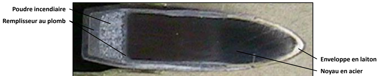
Figure I.9. Détails de l'intérieur d'une balle d'API-BZ (adaptée de [30]).
