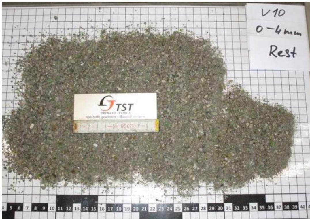
Figure 2-5. Fraction de sables de mâchefers 0/4 mm après TM/PM et criblage (BHS/TST)
