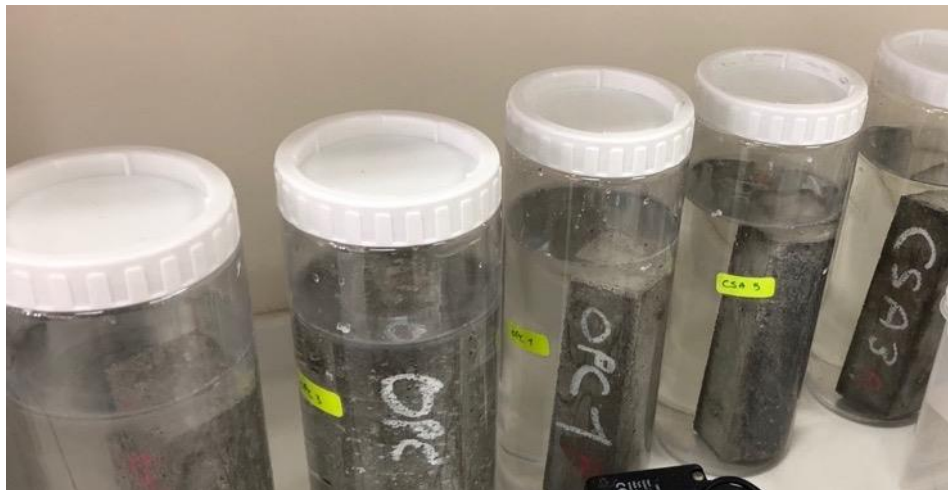
Figure 4-10 Réacteur contenant une éprouvette 4x4x16 cm plongés dans 1,024 L de solution saturée par rapport à la chaux contenant 44g/L de \text{Na}_2\text{SO}_4 .
