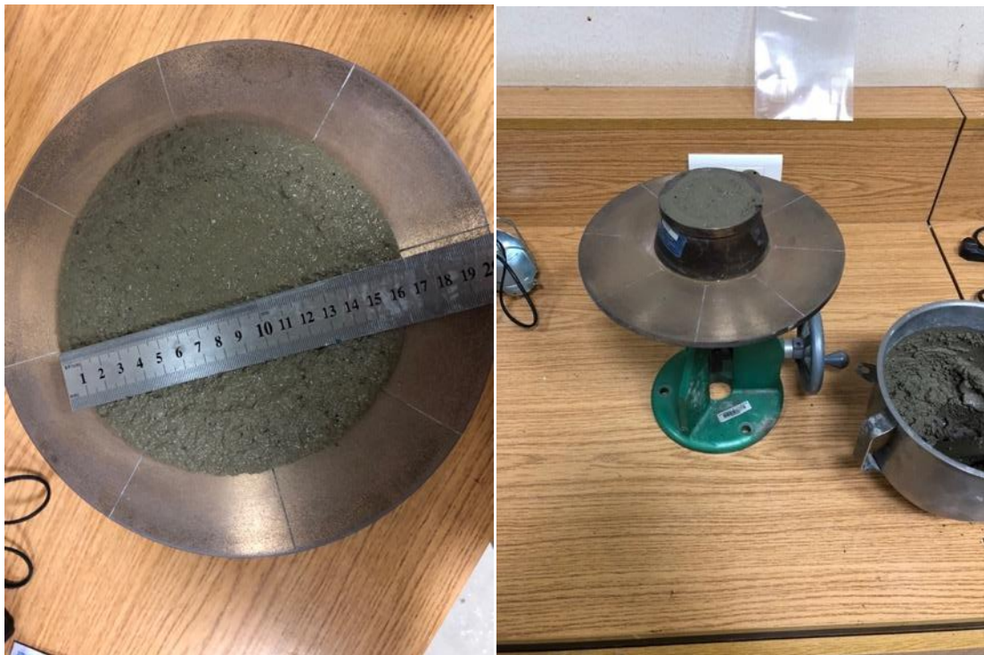
Figure 3-1. Dispositif expérimental de mesure de l'étalement sur la table à secousses
