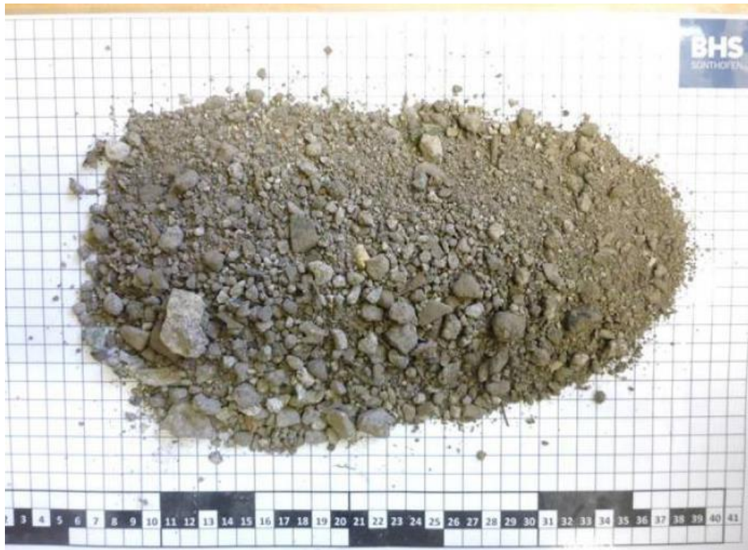
Figure 2-3. Fraction de mâchefers d'entrée 0/20 mm avant broyage BHS
