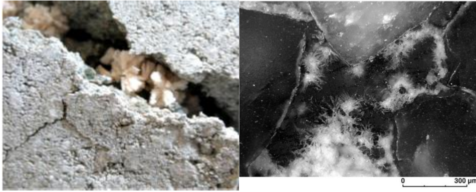
Figure 1-11. Formation de l'ettringite secondaire
