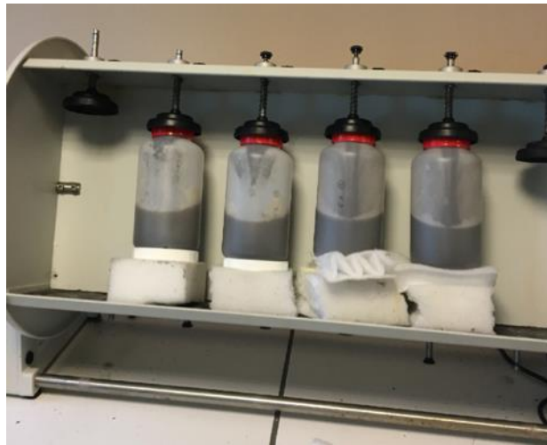
Figure 3-19 Dispositif expérimental de rotation pour les analyses de lixiviation selon la norme EN 12457-2 [82]
