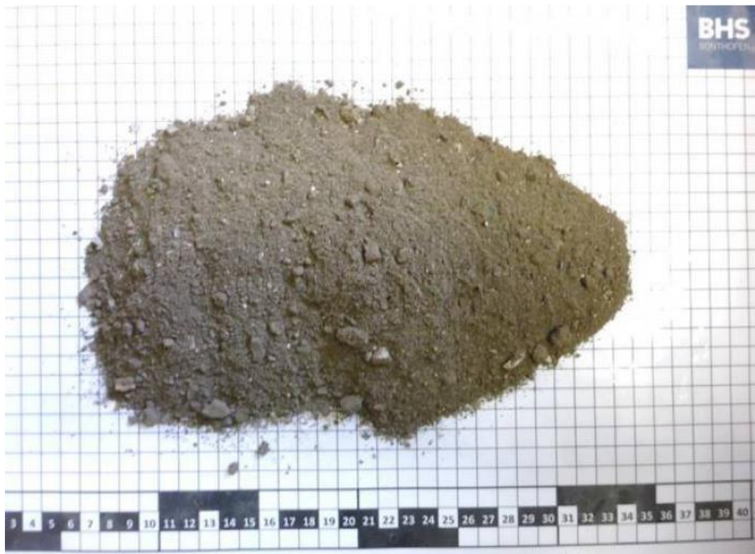
Figure 2-4. Fraction de mâchefers d'entrée 0/20 mm après broyage BHS
