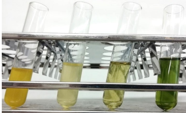
Figure 7: Photographie des quatre fractions obtenues en SFE avec de gauche à droite la fraction riche en: caroténoïdes, acide carnosique, acide rosmarinique et chlorophylles
