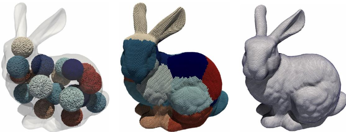
FIGURE 1.18 – Illustration de la méthode de maillage par SPH en parallèle (figures extraites de Ji et coll. [2020])
