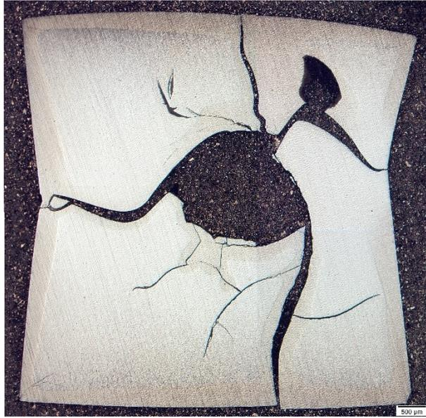
Figure 93 : Coupe axiale d'un cylindre de zircone 3Y observé par microscopie optique après un essai de frittage direct par micro-ondes. La partie centrale de l'échantillon s'est désolidarisée du reste de la pièce lors de sa découpe.
