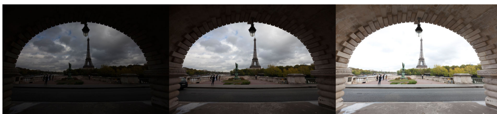
FIGURE 1.10 – Exemple d’illustration d’un système avec une plage dynamique faible. A gauche, l’image est sous-exposée causé par le manque de sensibilité et une durée d’exposition très courte. Au mieux, l’image est équilibrée. A droite, l’image est surexposée à cause d’une durée exposition longue qui sature le capteur. Source : http://www.plferrer.photos .
