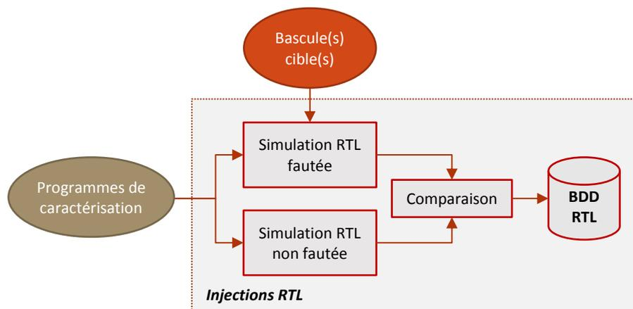
**FIGURE 32 : VUE D'ENSEMBLE DE L'INJECTION RTL. LES PROGRAMMES DE CARACTERISATION SONT UTILISES DANS DES SIMULATIONS FAUTEES ET NON FAUTEE. LES RESULTATS SONT COMPARES ET STOCKES DANS UNE BASE DE DONNEES**
