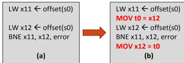
FIGURE 19 : REPRESENTATION DE L'ATTAQUE *REG\_WRITE* SUR UNE INSTRUCTION DE LECTURE MEMOIRE PROTEGEE PAR DUPLICATION COMPARAISON. BNE (BRANCH IF NOT EQUAL) EST L'INSTRUCTION DE BRANCHEMENT COMPLEMENTAIRE DE BEQ. L'ATTAQUE EST MODELISEE PAR UNE SAUVEGARDE DE LA VALEUR DU REGISTRE ASSEMBLEUR A2, PUIS UNE RESTAURATION JUSTE APRES LA CONTREMESURE.
