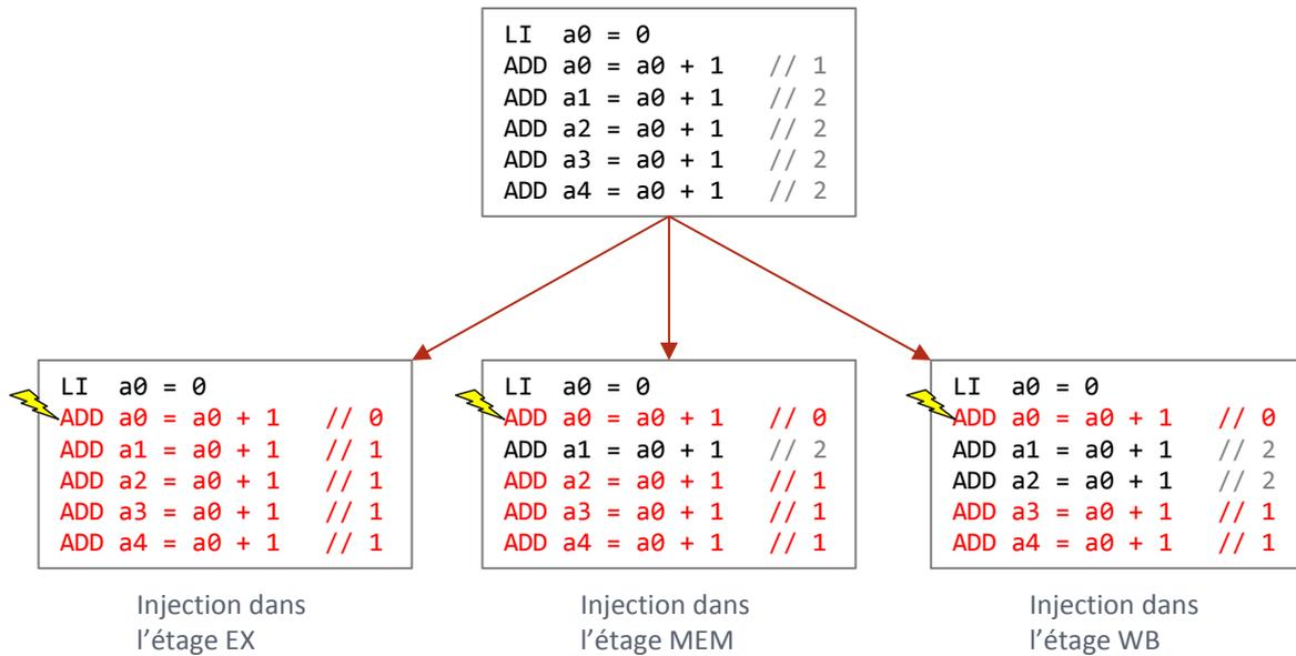
**FIGURE 13: CONSEQUENCES D'UNE ATTAQUE SUR LE SIGNAL REG\_WRITE, EN FONCTION DE L'ETAGE DE PIPELINE VISE**
