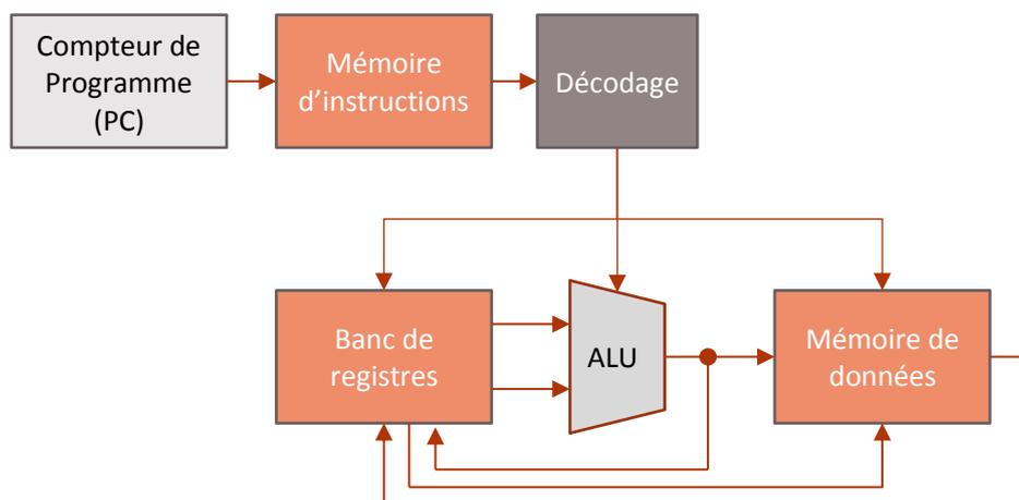
FIGURE 8 : REPRÉSENTATION BASIQUE D'UNE ARCHITECTURE DE PROCESSEUR
