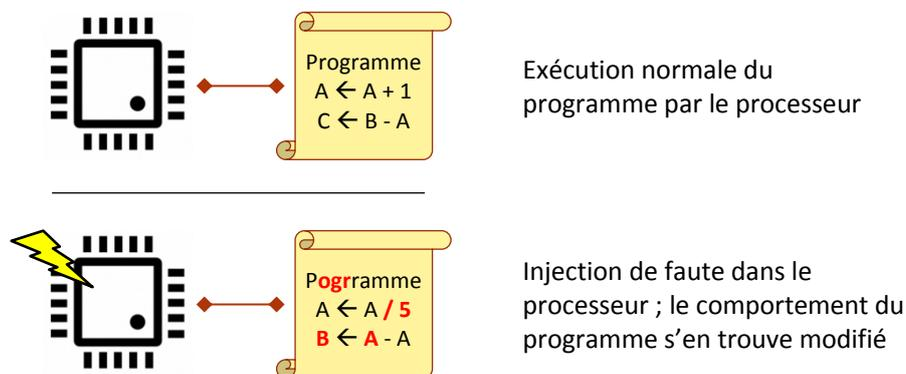
FIGURE 2 : PRINCIPE DE L'INJECTION DE FAUTE
