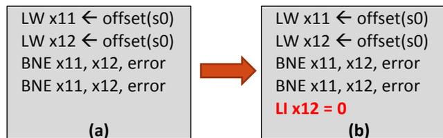
FIGURE 20 : REPRESENTATION DE L'ATTAQUE *REG\_WRITE* POUR UNE INSTRUCTION DE LECTURE MEMOIRE PROTEGEE PAR DUPLICATION ET DOUBLE COMPARAISON. LA DERNIERE INSTRUCTION DE COMPARAISON PEUT POTENTIELLEMENT ECRIRE 0 DANS LE REGISTRE ASSEMBLEUR X12.
