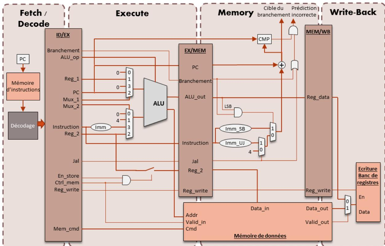
FIGURE 10 : MICROARCHITECTURE DU PROCESSEUR LOWRISC 0.2
