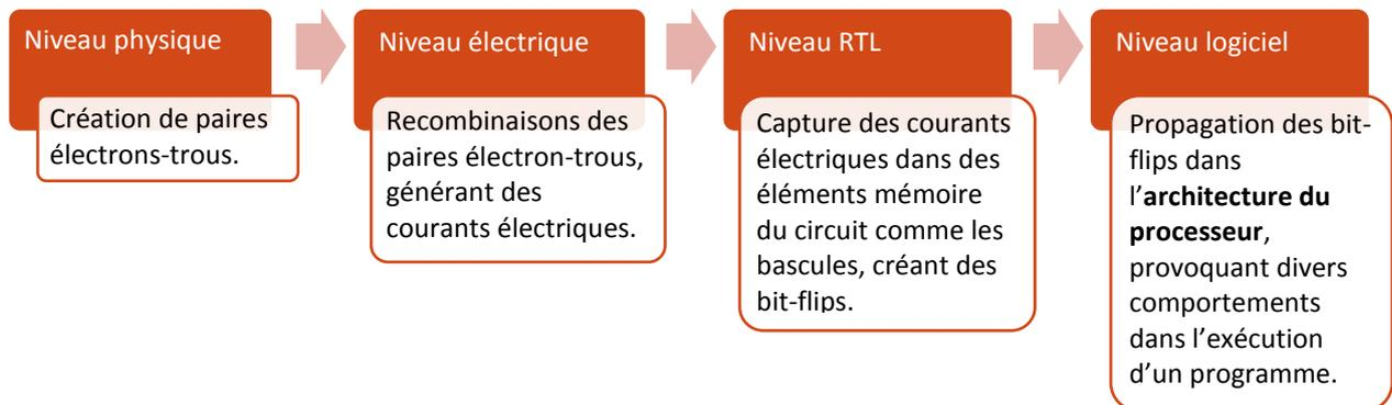
FIGURE 6 : NIVEAUX D'ABSTRACTION POUR LA MODELISATION D'ATTAQUES LASER
