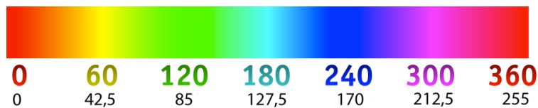
Figure 4-19. Représentation de l'échelle des teintes du système HSL, avec l'angle de Hue en degrés ( Figure 4-18 ) et la conversion en 8-bits (maximum de 255).
