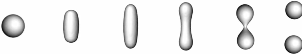
Figure 1.11: Fragmentation d’une goutte liquide en régime vibrational breakup ( We \approx 12 ).
