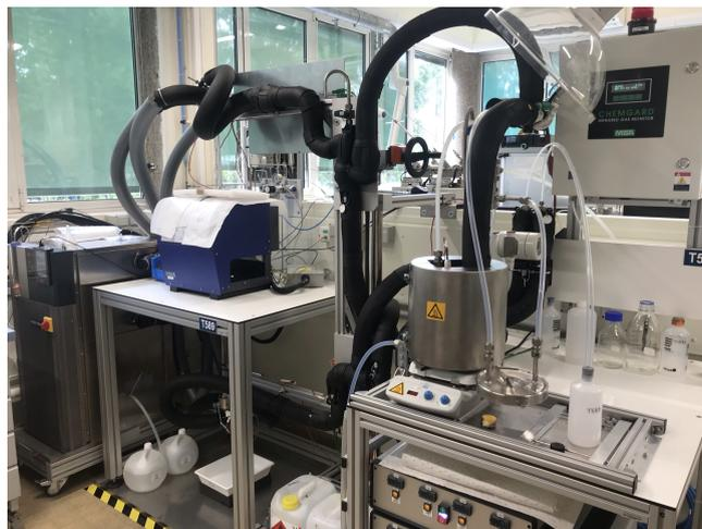
FIGURE 2.16 – *Photo du dispositif expérimental visant à étudier la formation de dépôts de paraffines.*
