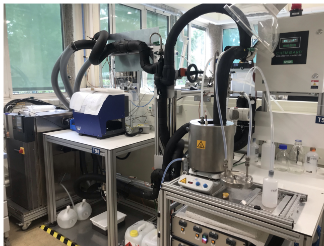
FIGURE 2.16 – Photo du dispositif expérimental visant à étudier la formation de dépôts de paraffines.
