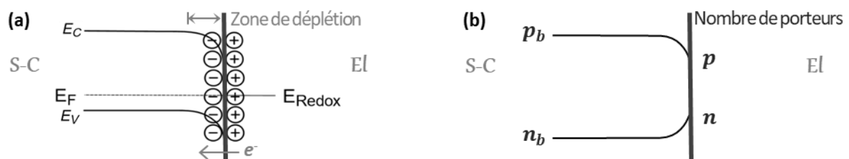
Fig. I.18 : Semi-conducteur type p : (a) courbure de bandes quand E < E_{FB} induisant une zone de charge d'espace en déplétion de trous, chargée négativement [118]. (b) Dépendance de la quantité de porteurs de charge au potentiel appliqué [115].
