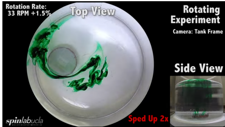
FIGURE 1.8 – Mise en évidence de l’effet Taylor-Proudman par une équipe du laboratoire de géoscience de l’UCLA. L’obstacle se situe au fond de l’eau et ne fait que 10% de la hauteur d’eau totale. Et pourtant l’eau est immobile dans toute la colonne située au dessus.
