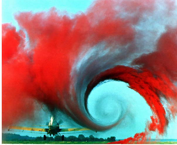
FIGURE 1.2 – Tourbillon généré par une aile d’avion au décollage mis en évidence par de la fumée colorée.
