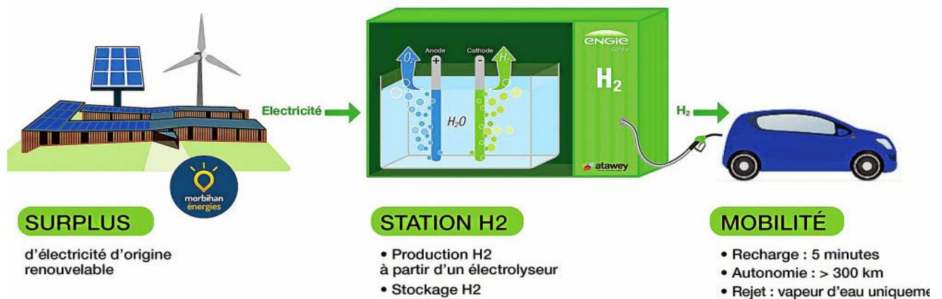
Figure 3. Site de production et de stockage de l'hydrogène
