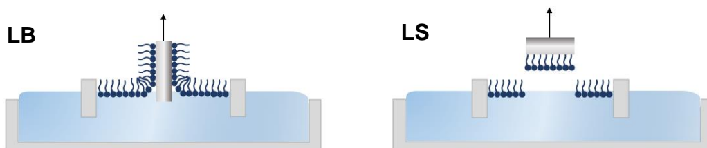
Figure 1.5 : Schéma de la méthode de transfert vertical Langmuir-Blodgett (LB) sur un substrat hydrophile (à gauche) et de la méthode de transfert horizontal Langmuir-Schaefer (LS) sur un substrat hydrophobe (à droite).
