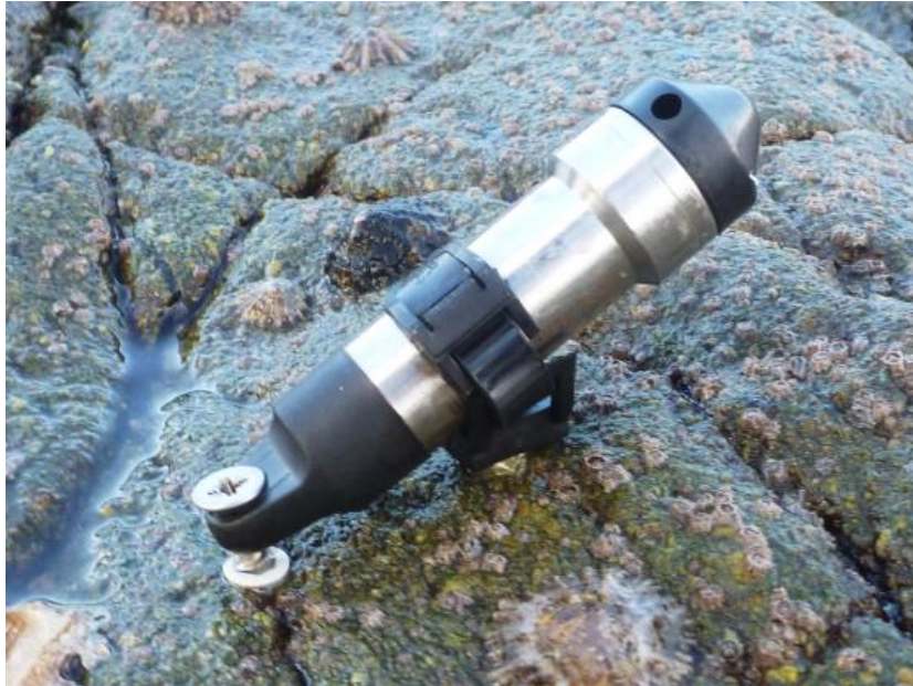
Figure 24 : Exemple de sonde de pression Mini-Diver® (SWS) fixée sur le substrat rocheux à marée basse.
