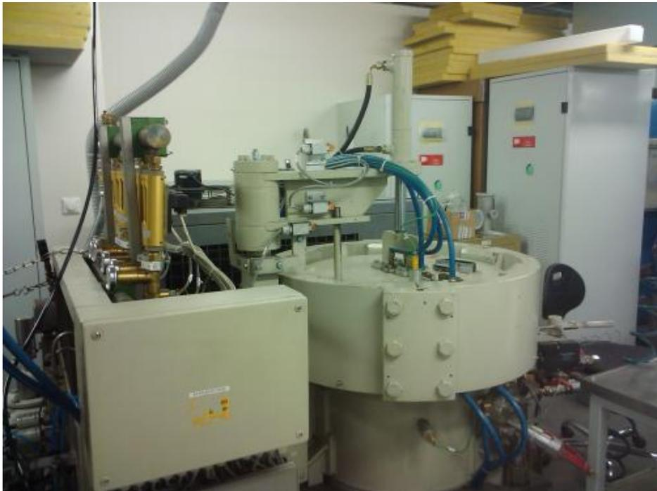
*Figure III-2 : Four de frittage (HIP) des WC [TUT].*
