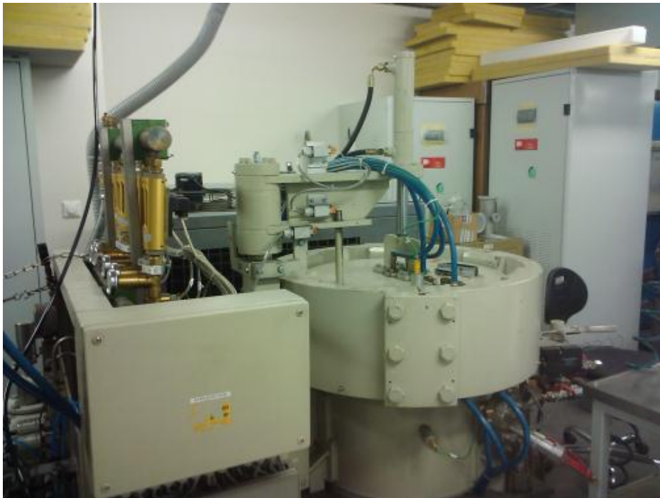
Figure III-2 : Four de frittage (HIP) des WC [TUT].
