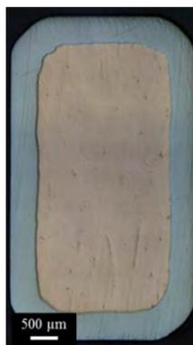
**Figure I.6** : Image de microscopie optique d'une section transversale du conducteur Cu-SS [9].
