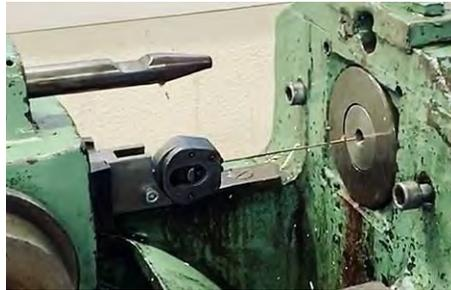
**Figure II.19** : Banc d'étirage à température ambiante au LNCMI, Toulouse.
