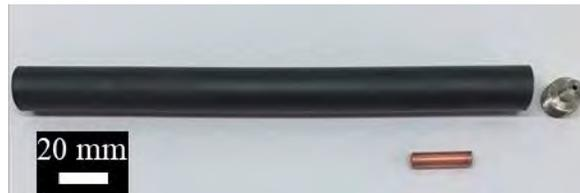
**Figure II.22** : Gaine acier inoxydable et barreau SPS.
