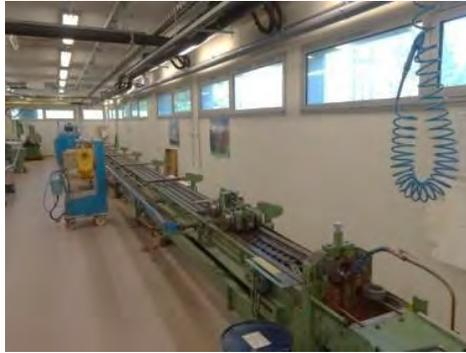
**Figure II.21** : Banc d'étirage du LNCMI.
