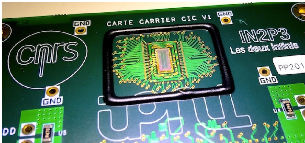
FIGURE 4.15 – Vue d'un CIC1 micro-câblé sur la mezzanine de test.
