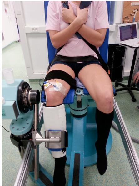
**Figure 4.5 :** *Installation du patient pour le test isocinétique sur machine Con-Trex MJ® (photographie Ronan Grimandi, HIA Clermont-Tonnerre, Brest).*
