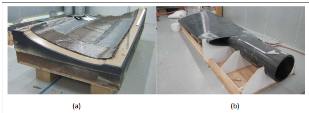
FIGURE IV.7 – Pale d'hydrolienne Sabella pendant la fabrication, (a) un côté du corps de la pale avant le processus d'infusion sous vide et (b) l'assemblage final avec longerons [12].
