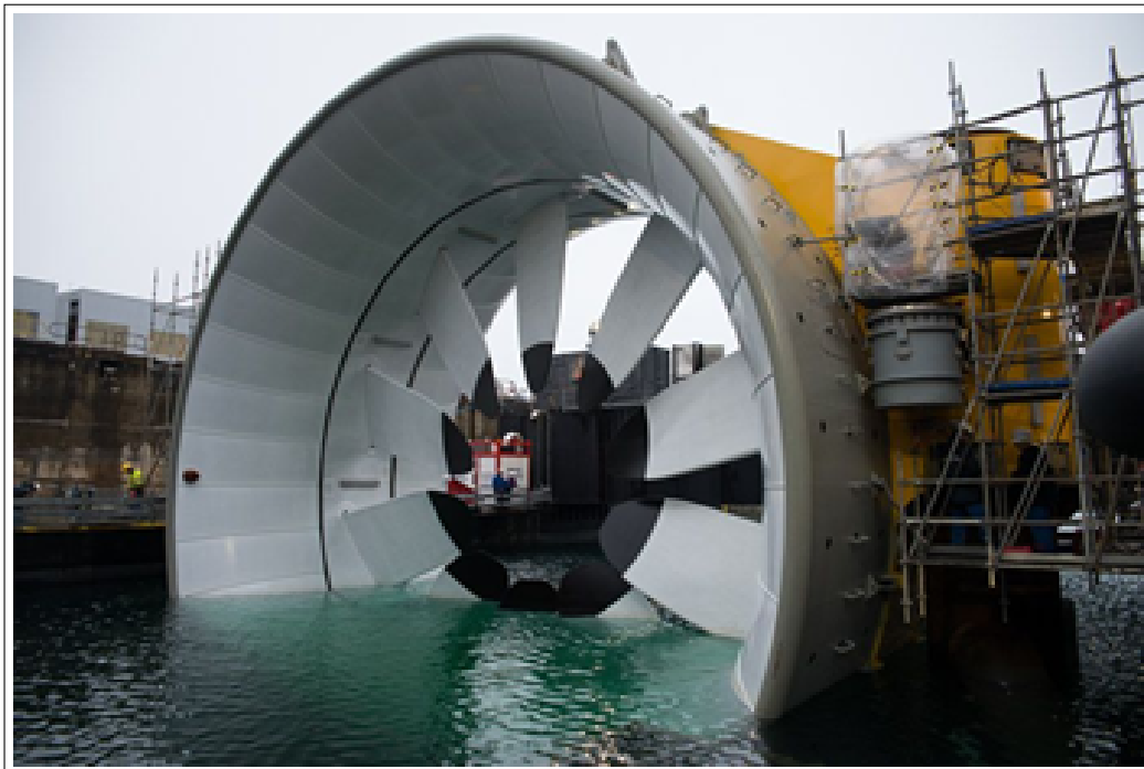
FIGURE IV.9 – Pales et carénage en composite de l'hydrolienne Open-Centre d'Open-Hydro.
