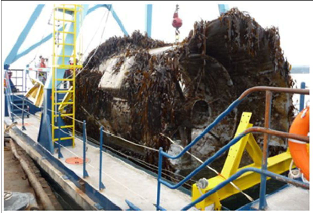
FIGURE IV.12 – Biofouling sur une hydrolienne immergée pendant trois ans au Canada, recouverte d’algues.
