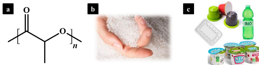
Figure 1. a) Structure chimique de l'acide polylactique (PLA), b) Billes de PLA utilisées pour la mise en forme de produits finaux c)
