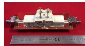
Figure 105 : à droite, visualisation du filtre en cordiérite avant métallisation, puis vue du prototype complet, à gauche comparaison de la mesure avec la simulation
