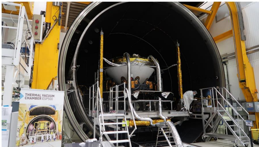
Figure 4 : Vue du module Exomars dans la chambre de test thermique - vide de Thales Alenia Space à Cannes Source : < Twitter Thales Alenia Space 5 >
