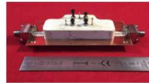
Figure 104 : à droite, visualisation du filtre en alumine avant métallisation, puis vue du prototype complet, à gauche comparaison de la mesure avec la simulation
