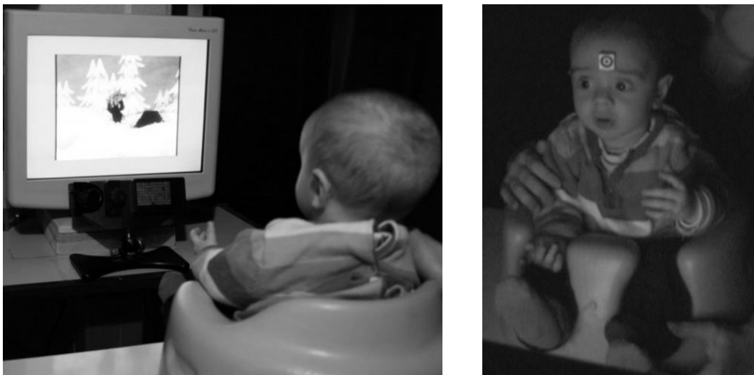
Figure 45 | Passation avec un nourrisson à l'oculométre. Le nourrisson est installé dans un fauteuil adapté, à 60 cm environ de l'écran. Une cible est installée sur son front pour l'enregistrement de ses mouvements oculaires. Le parent se tient derrière le nourrisson et reste en contact physique avec son enfant.
