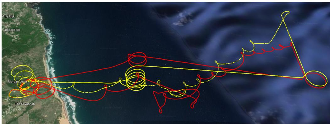
FIGURE 5.29 – Trajectoire KML de deux drones réalisant un échantillonnage sur le même nuage
