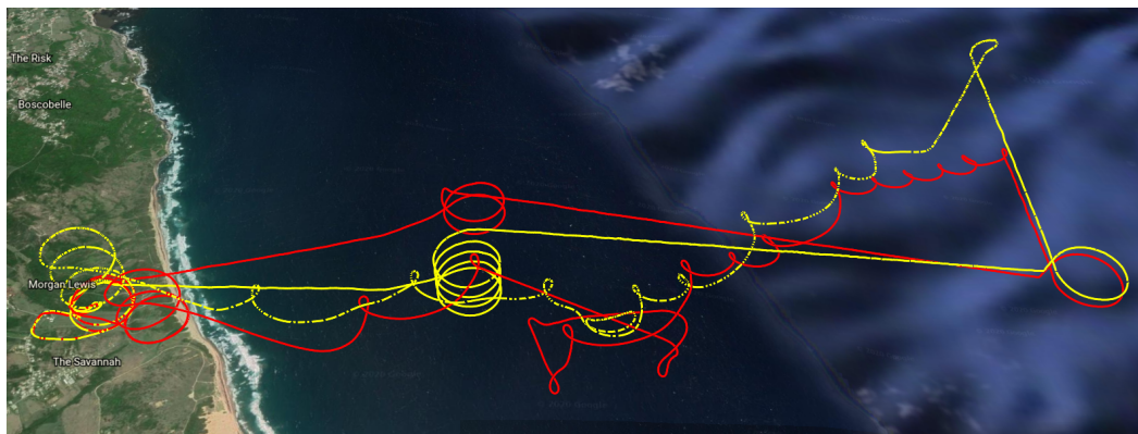
FIGURE 5.29 – Trajectoire KML de deux drones réalisant un échantillonnage sur le même nuage
