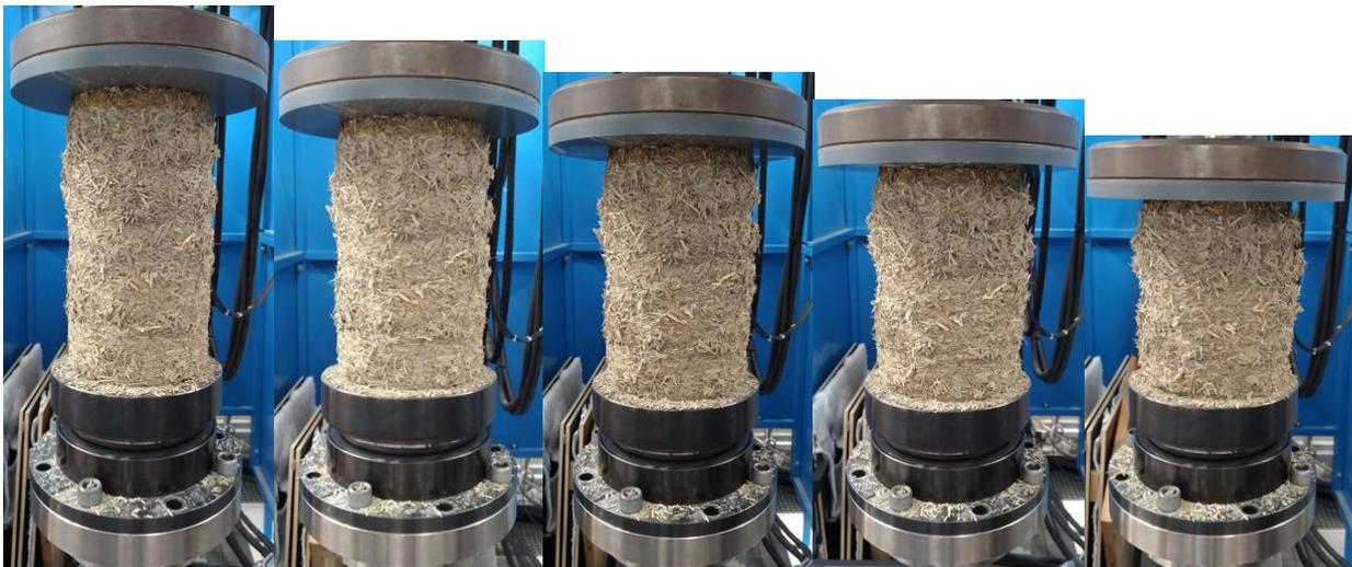
Figure 151 Exemple d'essai de compression à grande déformation sur cylindre ADEV3
