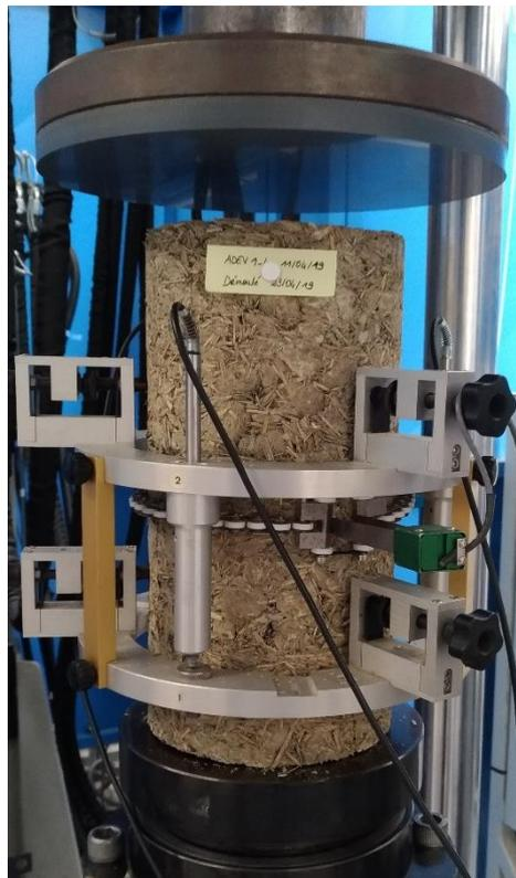
Figure 150 Éprouvette ADEV1 avec dispositif d'acquisition de déformation extensomètre sur machine Zwick
