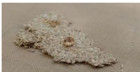
Figure 69 Goutte d'eau sur de la farine de phragmites compressée
